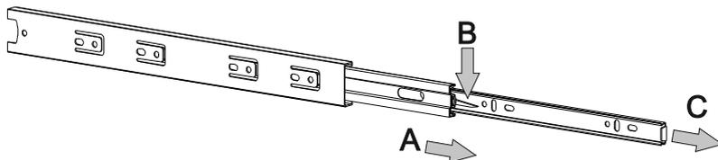
Внутренняя (узкая) часть устанавливается на боковые панели ящика
