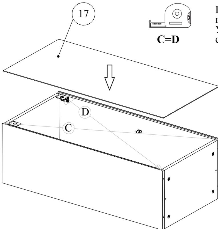
Перед установкой задних стенок проверить диагонали каркаса. Установку производить только при совпадении диагоналей.
