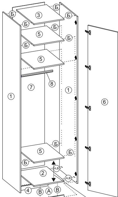
для возможности установки выдвигающих блоков расстояние между полками должно составлять **336 мм**
