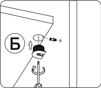
**Б** - эксцентриковая стяжка усиленная
